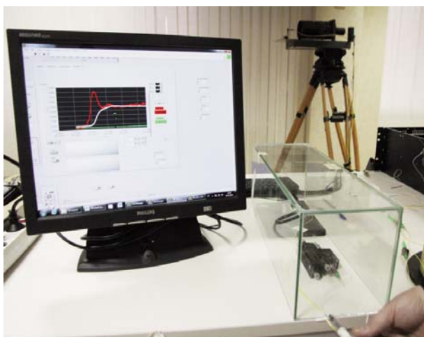
Успешные испытания волоконно-оптического сигнализатора метана
